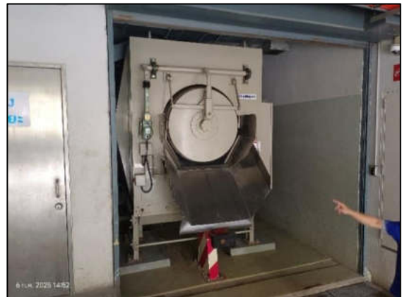
รูปที่ 2-20 เครื่องอัดขยะ
